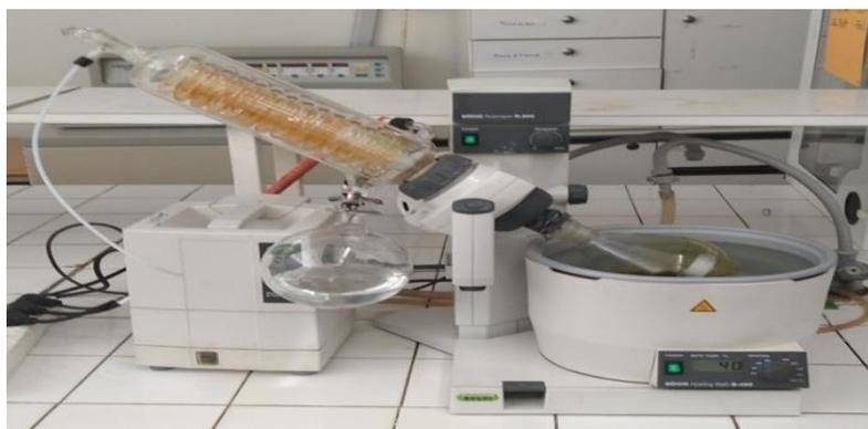
Figure 33 : un évaporateur rotatif
