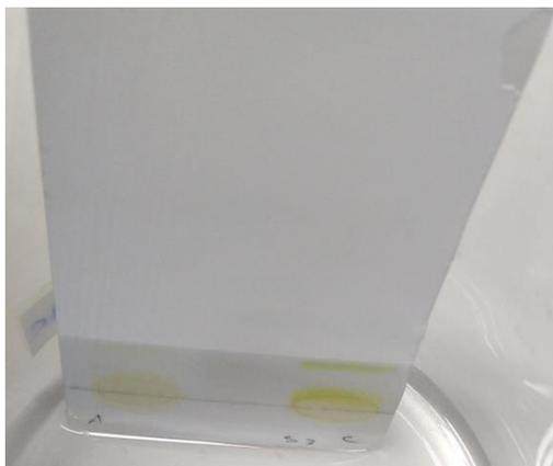
**Figure 35:** plaque CCM dans le système toluène/ AcOEt
